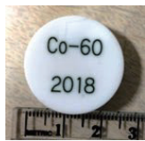
図 5 使用した放射線源 ^{60}\text{Co} (と大きさ比較用のものさし)
