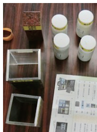
図 12 特性実験セット。円筒形の容器内に船底資料・湯の花・カリ肥料・塩が入っている。花崗岩は四角柱形。左下は遮蔽ブロック大・小。
