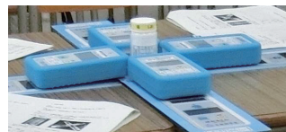
図 13 受講生が、特性実験セットと CP-100(4 台)を用いて、普通教室の机上で実際に測定している様子。真ん中の円筒形のものは測定用試料。写真のように付属の台紙を用いると、試料からの距離が簡単に設定できる。(机上の周りの紙はワークシート。)
