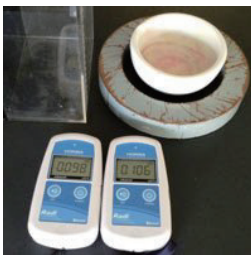
図 4 下の 2 台が PA-1100 であり, 左上がプラケース, 右上がすり鉢 (内側) と厚い鉄の輪 (外側)。
