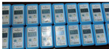
図 11 簡易放射線測定器はかるくん CP-100 (シンチレーションカウンター)。本体には「文部科学省」と書かれている。文科省に問い合わせたところ、これに相当する市販されている機種はクリアバルス Mr.Gamma A2700 である。
