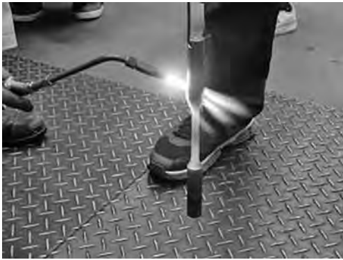
図4：試験片の熱処理作業
