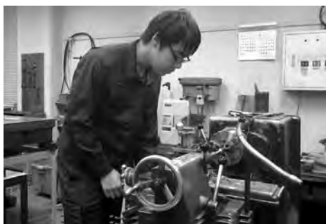
図2: 旋盤による丸棒試験片の製作
