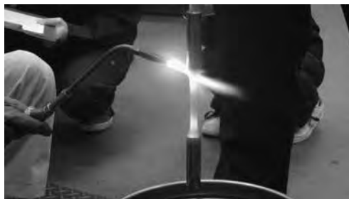
図3: S45C 試験片の焼入れ作業
