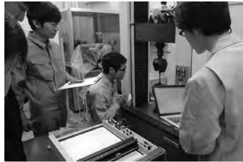
図5: 丸棒試験片の引張試験
