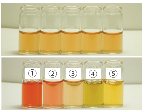
図 9-2 上段は、黒米 2.5 g から水 100 ml で抽出した指示薬 3 ml のみ。下段①はサンポール、②はミツカン酢、③は水、④は食器洗いせっけん、⑤はハイターを 1 ml 加えたものである。
