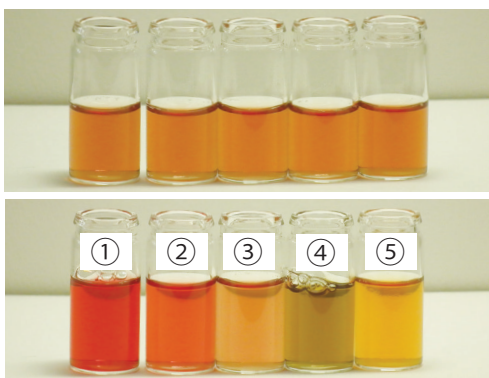
図 9-3 上段は、黒米 5.0 g から水 100 ml で抽出した指示薬 3 ml のみ。下段①はサンポール、②はミツカン酢、③は水、④は食器洗いせっけん、⑤はハイターを 1 ml 加えたものである。
