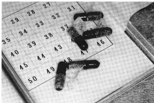
図2 Thermoluminescent Dosimetry 素子: TLD 素子
