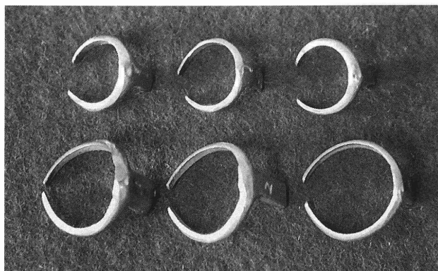
図3 0.5mm変形に要する外力を測定したレスト付二腕鉤
