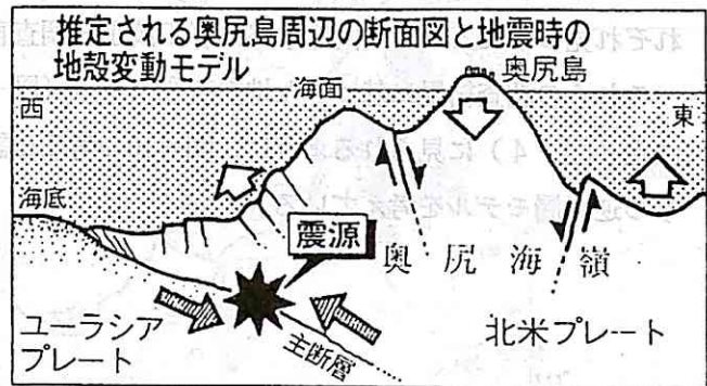
図-10 地震時の推定地殻変動モデルの1例 (東大震研阿部勝征氏による、北海道 新聞による)
