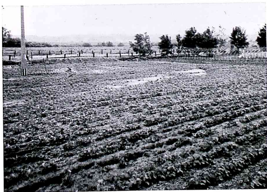
写真-10 今金町豊田、水田の噴砂、畠地のクラックと噴砂
