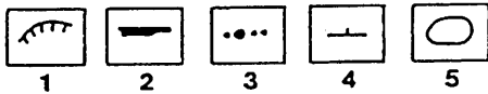
破線: 見かけの等高線, X-Y: 図-10の断面線, 1: 古期滑落崖, 2: 古期地溝性亀裂, 3: 地すべり性ドリネ, 4: 基盤ブロックの走向と傾斜, 5: 池
