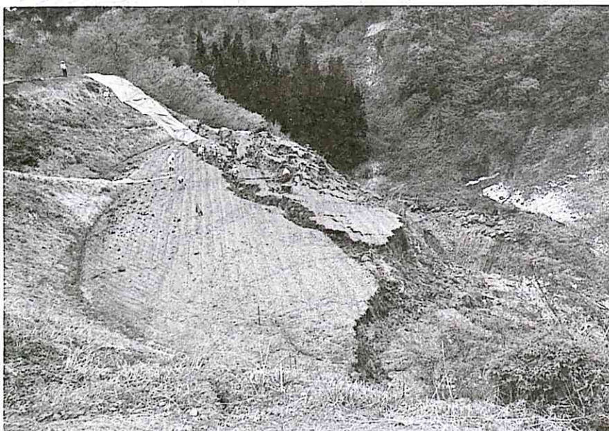
写真-2 崩壊の上部にある水田の状況。段差亀裂が入り落ち残った土砂が今にも滑落しそうである。
