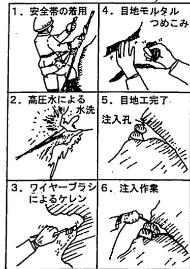
図-4 岩接着工法説明図
