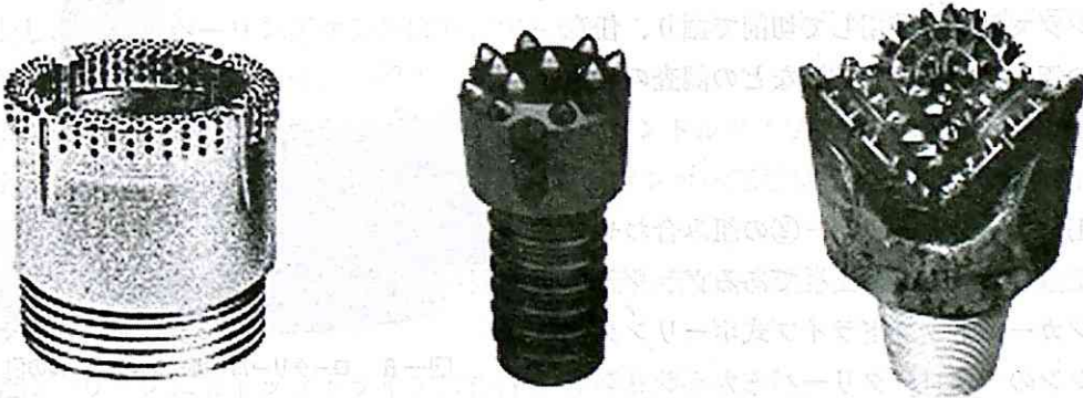
図-4 左より切削・打撃・圧削ビットの各例
