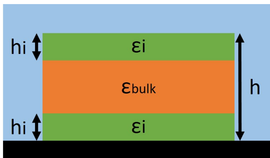
図7 グラフェン近傍のグラフェンの面に垂直な誘電率を得るために用いた理論モデルの模式図。このモデルでは上面と底面の中性物質から h_i だけ離れた距離までの緑色の領域が誘電率 \epsilon_i のコンデンサで、残りの赤の領域がバルク水の誘電率 \epsilon_{bulk} = 80 としている。
