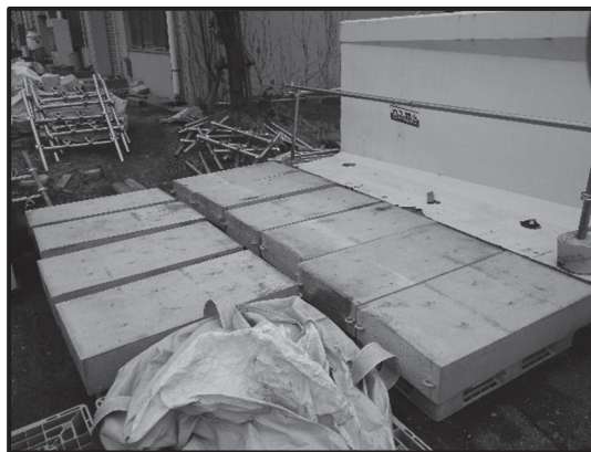
図-7.2.7 大型供試体暴露状況
