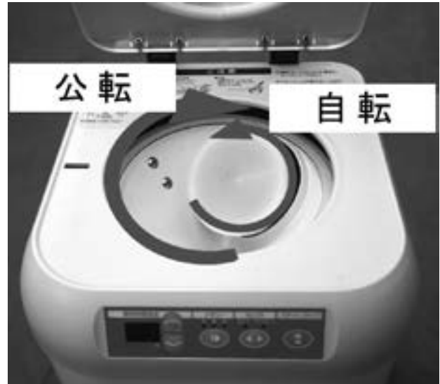
図1 実験に用いた公転・自転式ミキサー。矢印は公転および自転の方向を示す。
