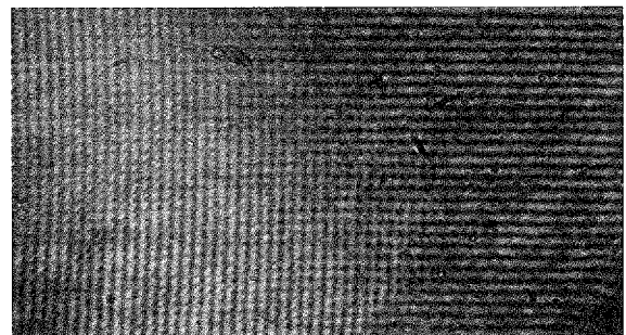
図2 CCD 上の干渉縞
