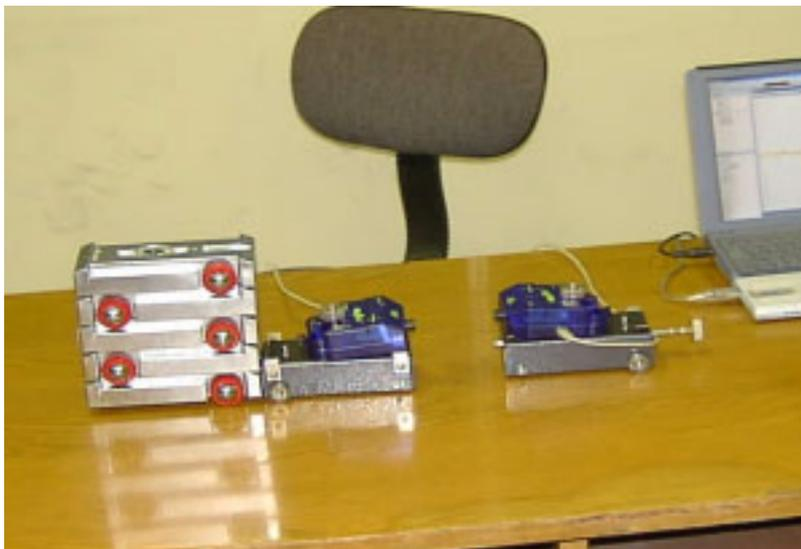
その後、2つの力センサーを使ってその予測を検証するという授業を行った。それぞれが受ける力（作用力と反作用力）をリアルタイムで検証した力センサーによる測定結果を下図に示す。ここでは、トラックが及ぼす右向きの力が正（上部の曲線）、軽自動車の左向きの力は負（下部の曲線）に表示されるが、相互に及ぼしあう撃力は千分の1秒単位まで相等しい（上下に対称なグラフである）ことが見事に示されている。
