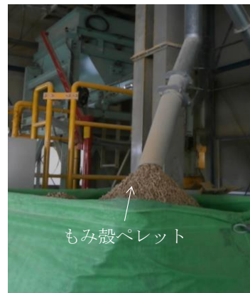
写真 2-2 もみ殻ガス化プラントの外観ともみ殻ペレットの製造過程
