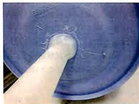
図 2-5 耐水性ボンドによる固定
