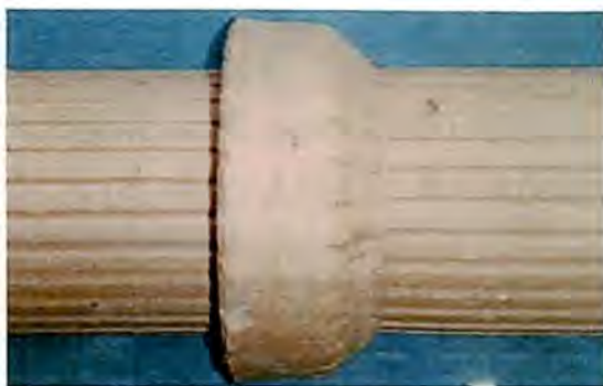
写真 2-1 陶管暗渠の接合部、表面直溝
