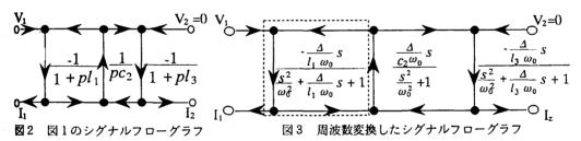
図3において、まず破線で囲まれた部分について考える。この部分のシグナルフローグラフ(図4(a))と等しい伝達関数を持つ回路を、演算増幅器の周波数特性を考慮した微分器を用いて構成すると、図4(b) のようになる。図4(a)、(b)の伝達関数は演算増幅器の利得を GB/s とすると、それぞれ式(1)、(2)で表される。このとき、式(1)、(2)の係数を比較して素子値を定める。但し、 $\omega_H$  は式(3)の範囲で定めなければならない。同様に、残りの部分もこの構成法を応用して能動化する。
