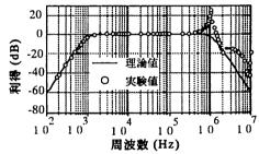
図7 振幅特性 2  $(\omega_L=2\pi\times1\times10^{4} \text{ rad/s}], \omega_H=2\pi\times1\times10^{4} \text{ rad/s}]$
