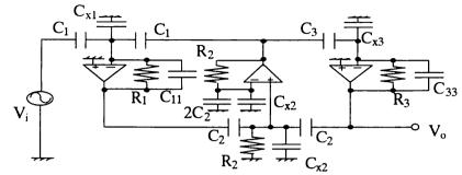
図5 能動RC帯域通過回路
