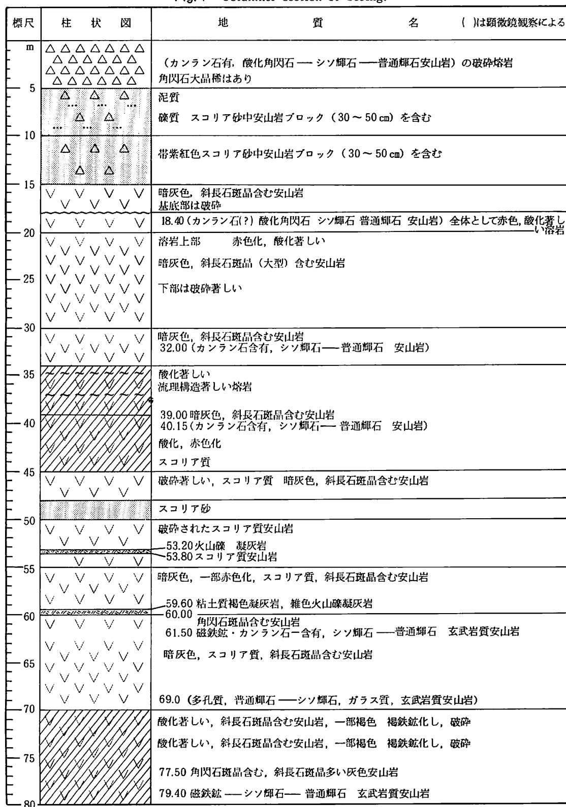
図-1 ボーリング柱状図 Fig.1 Columnner section of boring.
