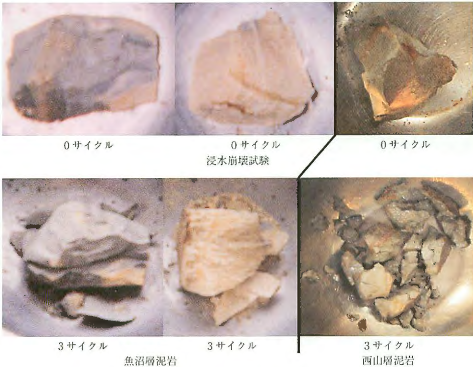
写真-20 湿润崩壊試験状況
