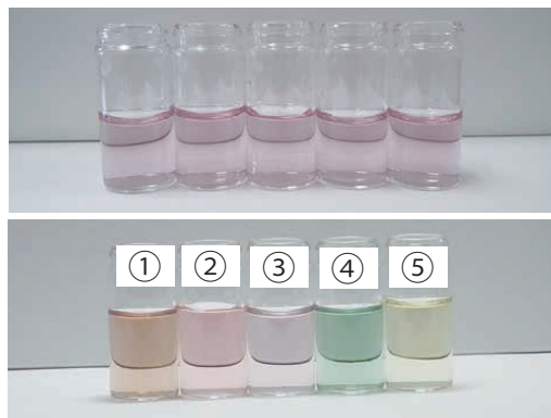
図 11-1 上段は、ムラサキイモパウダー 1 g から水 100 ml で抽出した指示薬 3 ml のみ。下段①はサンポール, ②はミツカン酢, ③は水, ④は食器洗いせっけん, ⑤はハイターを 1 ml 加えたものである。
