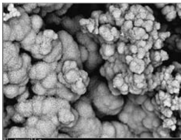
図1 リン酸緩衝液浸漬14日後のMTA表層析出物のSEM像 フーリエ変換赤外分光法により, アパタイト構造を含むリン酸カルシウムであることが確認されている 5) 。
